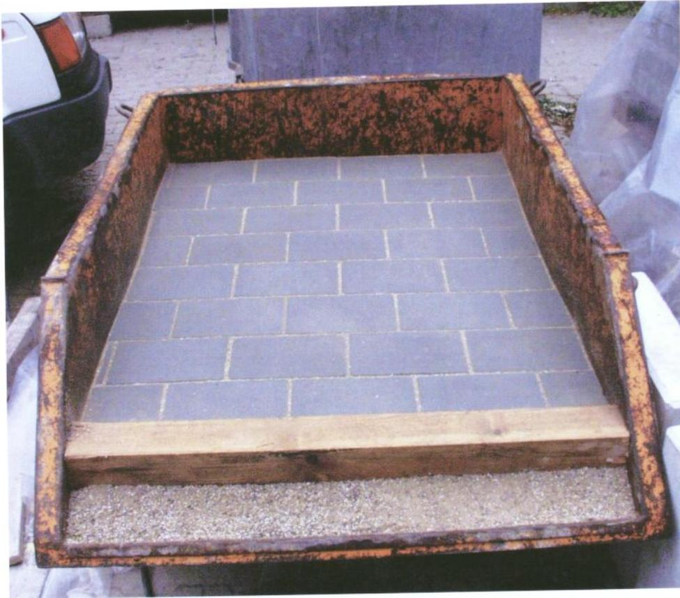
Bild Nr. 1. Ansicht der Pflasterfläche vor Infiltrometerversuch
